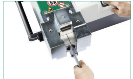
Werkzeugkopf zum 37°-Bördeln mit manueller Druckeinstellung
