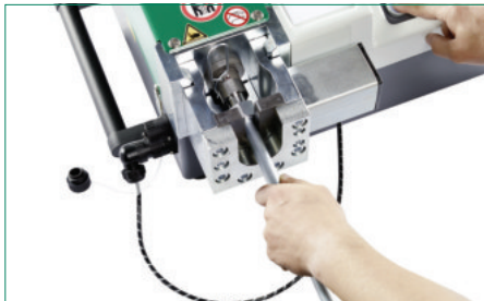
Werkzeugkopf zur Schneidring-Montage mit automatischer Druckeinstellung / Größenerkennung
