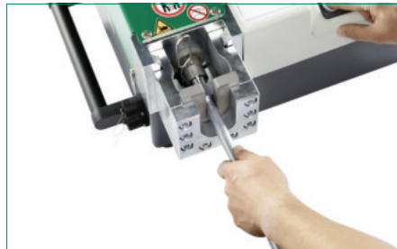
Werkzeugkopf zur Schneidring-Montage mit manueller Druckeinstellung
