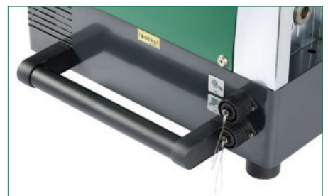
Anschlüsse für Werkzeugkopf zur Schneidring-Montage und für Handschalter (optional erhältlich)
