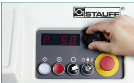
Bedienbereich der Montagemaschine mit Bedienknopf mit Druck- und Drehfunktion sowie Parameteranzeige
