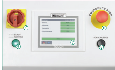
Bedienbereich der Rohrformmaschine
